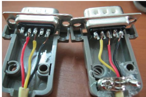
รูป การต่อ DB-9 ตัวผู้ เมื่อมองจากด้านหลัง
