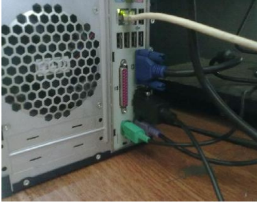
รูปเสียบสาย RS-232 เข้ากับ Port คอมพิวเตอร์
